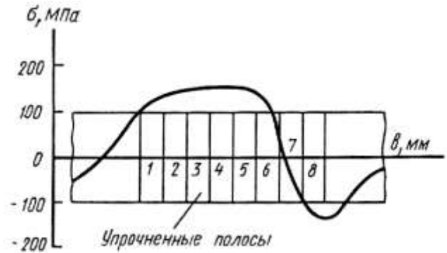
Рис. 45. Распределение остаточных напряжений поперек полос упрочнения на поверхности прутка из стали 40X после обработки непрерывным \text{CO}_2 -лазером
